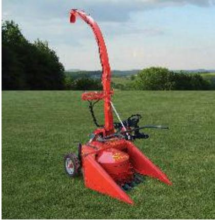
切刀和喂入器將玉米送入餵料裝置。喂入系統使莖稈以垂直的角度喂入飛輪保證了青貯的高品質產出。飛輪裝有10個特質的鋒利刀片，其轉速接近1400rpm。兩個喂入滾筒和兩個壓鋸可以控制玉米莖稈向飛輪的喂入，其中一個壓鋸裝有彈簧和齒。壓鋸垂直安裝在喂入滾筒的後部，以保證總以垂直的角度切割莖穗。這就是這台青貯收穫機的低能耗和低割茬的秘密所在。此外，為了保護餵料系統，機器特別安裝了一個簡易的保險螺栓。
